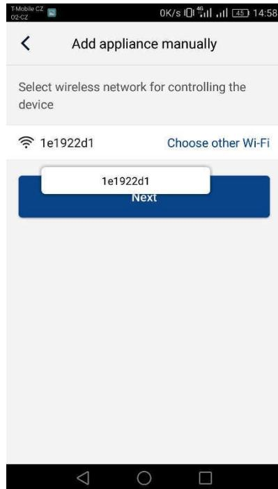
6. U okviru sljedećeg koraka odaberite Wi-Fi mrežu na koju želite priključiti jedinicu. Popunite i lozinku i nastavite pritiskom na tipku „Submit“.
